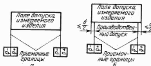
**2-й способ.** Приемочные границы устанавливают смещенными относительно предельных размеров внутрь поля допуска изделия (устанавливается производственный допуск — см. чертеж, б).
