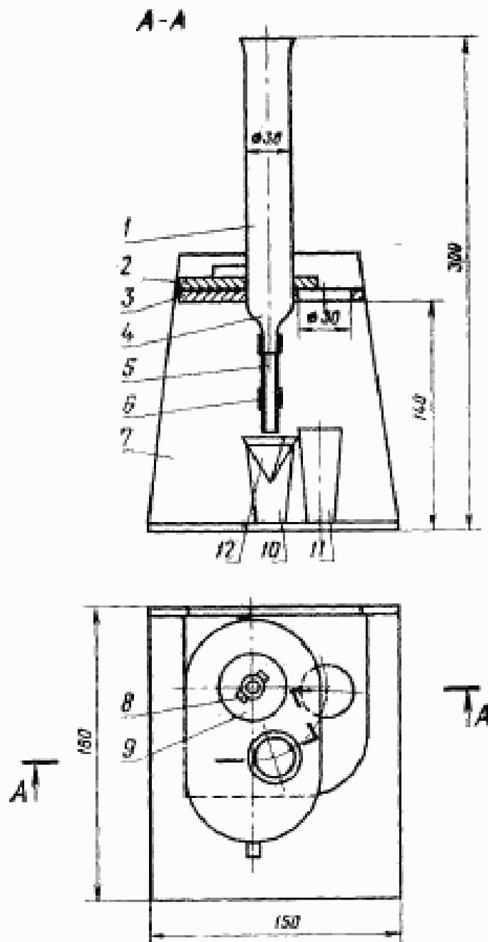
1—цилиндр; 2—верхняя подложная пластина; 3—нижняя пластина; 4—приемная воронка; 5—резиновая трубка; 6—зажим; 7—стойка; 8—болтовое соединение; 9—шайба; 10—стакан для раствора с минеральными примесями; 11—стакан для раствора с частицами шпаты; 12—фильтр
