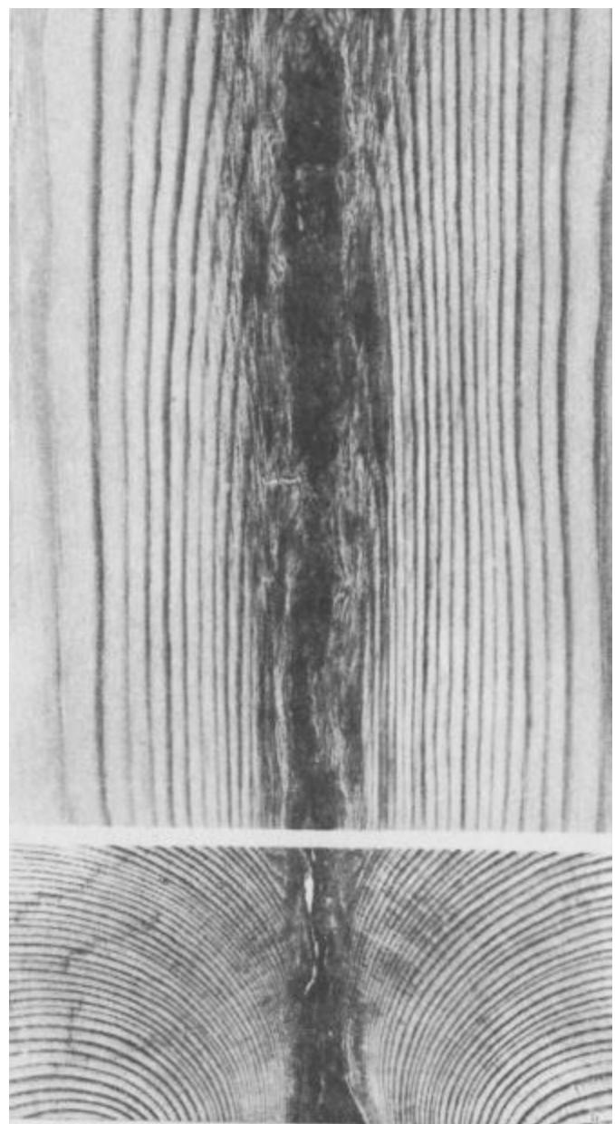
2 - сквозная на тангенциальной и торцовой поверхности
