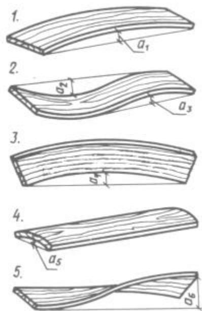
*1* - простая; *2* - сложная ( $z = a_2$  при  $a_2 > a_3$ ;  $z = a_3$  при  $a_3 > a_2$ ); *3* - продольная по кромке; *4* - поперечная; *5* - крыловатость
