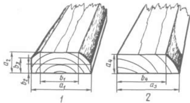
1 - тупой ( $z_1 = a_1 - b_1$ ;  $z_2 = a_2 - b_2$  при  $b_2 < b_3$ ,  $z_2 = a_2 - b_3$  при  $b_3 < b_2$ ); 2 - острый ( $z_3 = a_3 - b_4$ ;  $z_4 = a_4$ )
