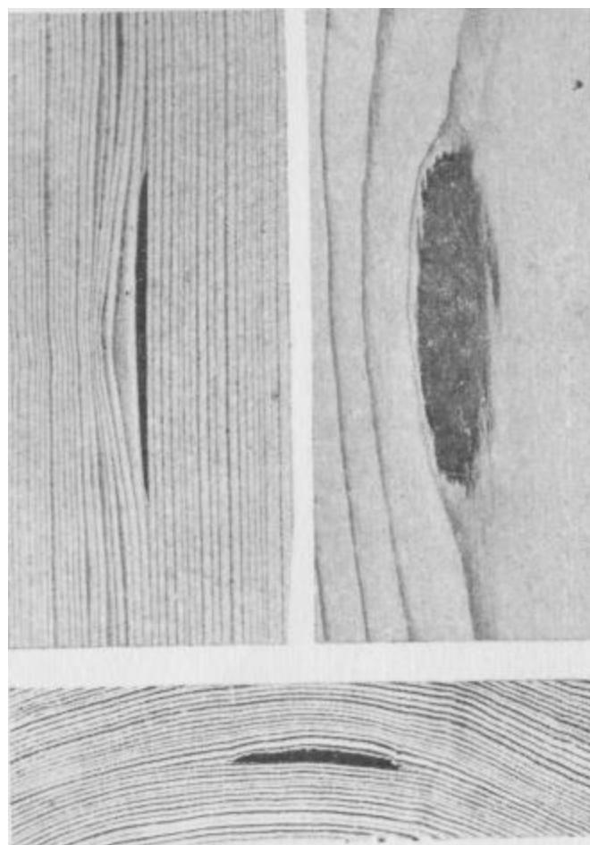
1 - радиальный разрез; 2 - тангенциальный разрез; 3 - торцовый разрез
