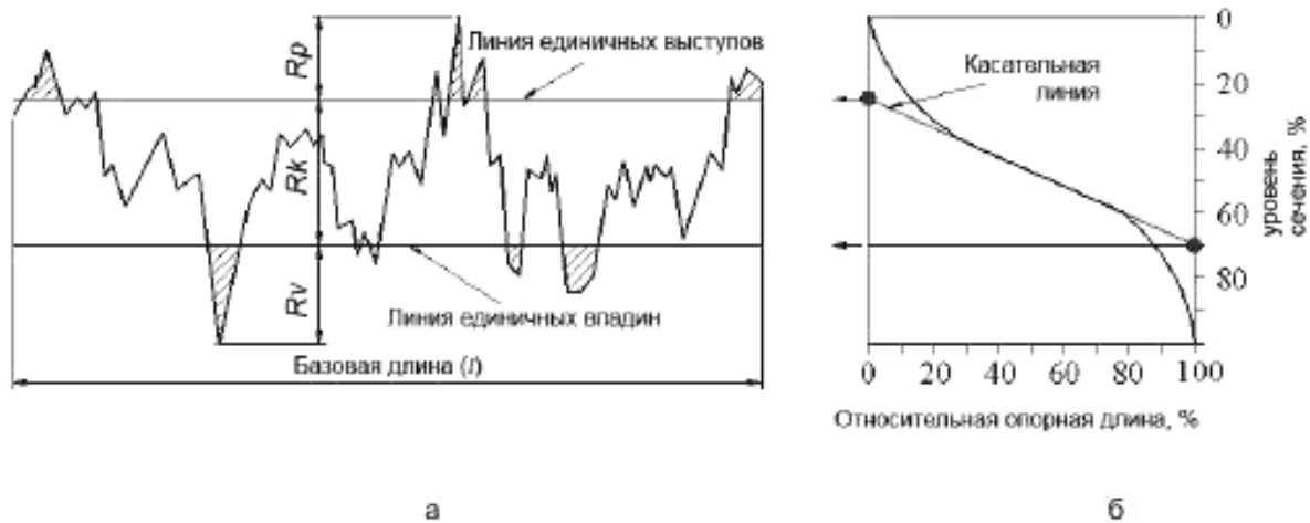
а) профилограмма; б) относительная опорная кривая
